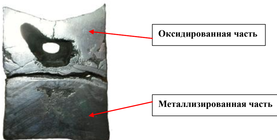
Рис. 3.29. Вид продольного разреза слитка эксперимента CORD37
