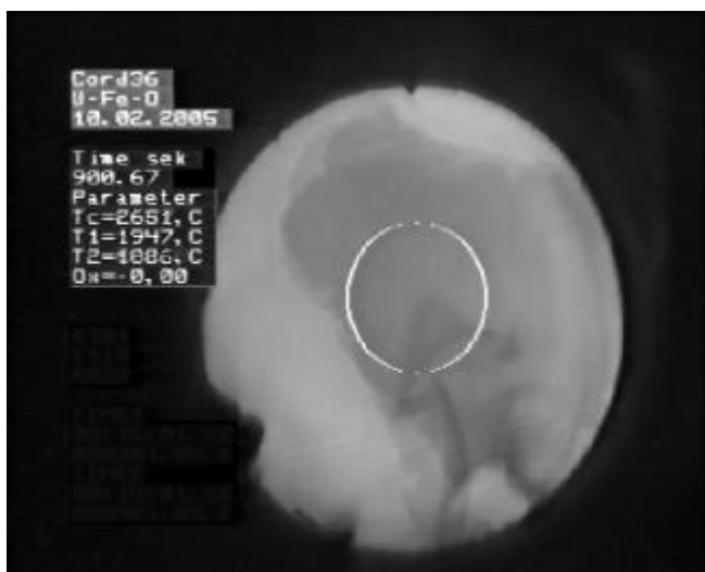
Рис. 3.2. Видеофрагмент поверхности ванны металлического расплава
