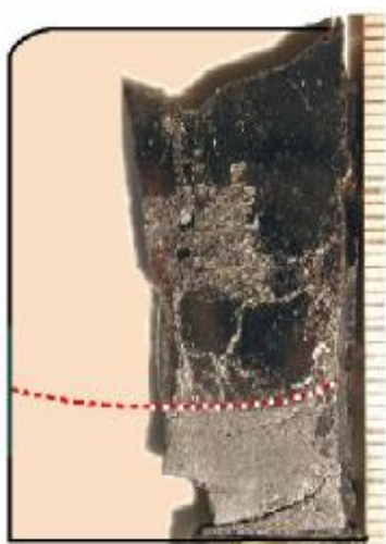
Рис. 3.7. Продольный разрез слитка эксперимента CORD36
