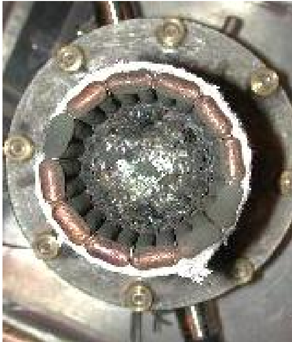
Fig. 1.10. Corium ingot in the cold crucible
