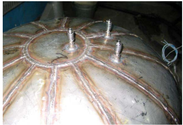
д) Плу́нжеры для передачи деформации к датчикам
