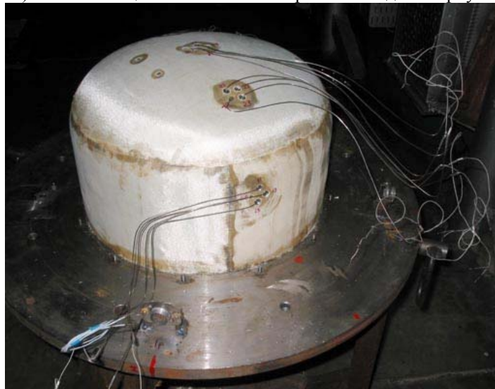
б) Установка термопар в образцы корпусной стали
