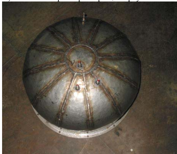
в) Защитный стальной экран на внешней поверхности модели корпуса
