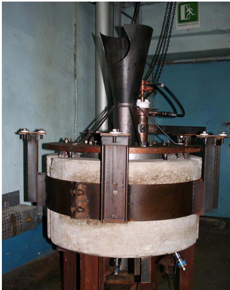
е) Установка модели корпуса на бетонное основание
