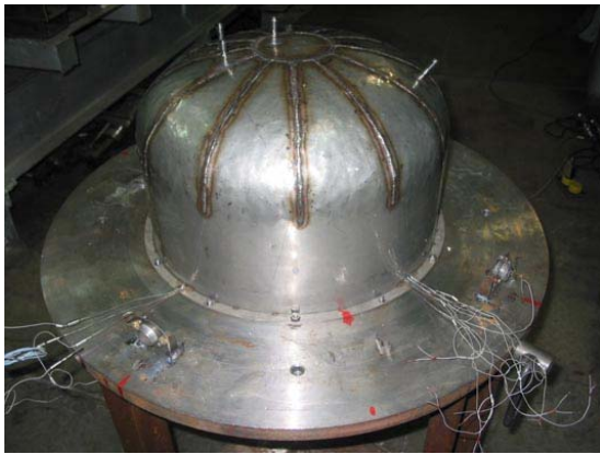
г) Трассировка выводов термопар
