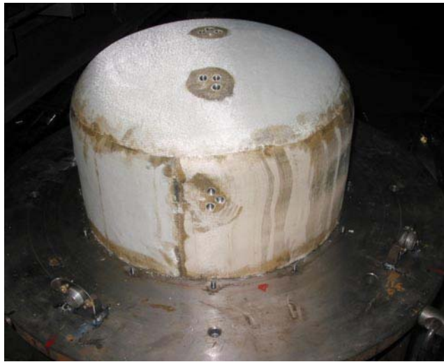
а) Теплоизоляция на внешней поверхности модели корпуса
