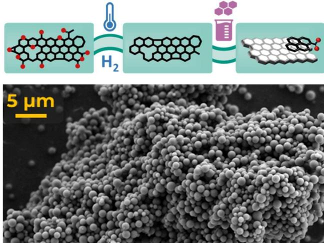
Im Rahmen dieser Arbeit soll nach Synthese der sphärischen Hard Carbons deren Oberfläche durch eine anschließende Behandlung mittels sauerstofffunktionalisierten Pyrenderivaten selektiv modifiziert werden.
